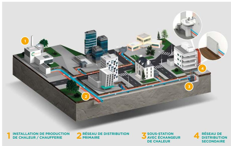
Le chauffage urbain, véritable outil industriel au service de la collectivité, transporte de la chaleur sous forme d'eau chaude au moyen de canalisations sous voirie. Les canalisations enterrées acheminent la chaleur et la distribuent aux bâtiments raccordés (équipements municipaux, logements collectifs...). La chaleur sera produite à partir de deux chaufferies interconnectées ce qui permettra une excellente disponibilité de service.
